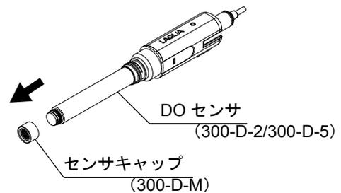
2. 新しいセンサキャップをしっかりと締め付けます。
