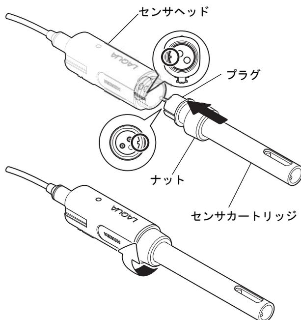
1. センサカートリッジのプラグ部の溝をセンサヘッドのガイドに合わせて挿入します。
