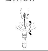
注記▶▶▶ 電極の隔膜は薄く破れ易いため、静かに液中に入れてください。
