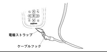
注記▶▶▶ ケーブルのフックは必ず取り付けてください。フックを取り付けずに使用するとケーブルが断線する恐れがあります。
