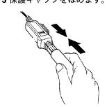
注記▶▶▶ 保護キャップ内が乾燥した状態で電極を長期間保存すると電極 の応答速度や感度が低下することがあります。
