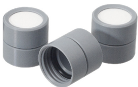
Membrana de electrodo NH 3 Número 3200705774
