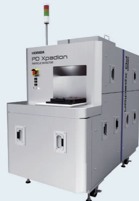
レティクル/マスク異物検査装置 PD Xpation (PD10)
