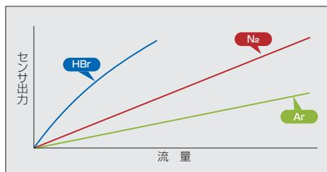
プロセスに使用されるガスは様々な物性を持っています。このためSEC-Z500Xシリーズが採用した流量校正機能は、個々のプロセスガスにおける流量特性を流量レンジ毎に高度に計測したデータに基づき校正を行います。膨大な計測データと信頼性の高い流量センサ、最新の校正技術により高精度なプロセスガス流量の制御を実現しました。
