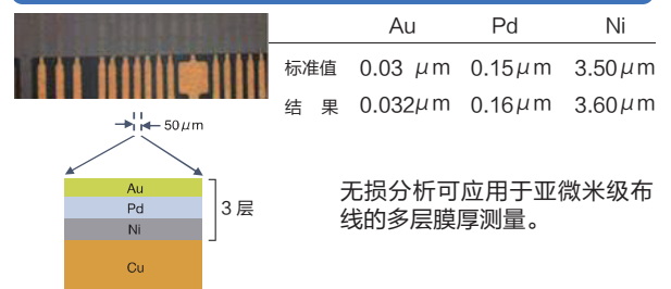
精细布线图形的镀层厚度分析
