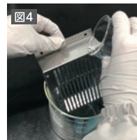
図4 ビーカに対して大きい部品の 場合、油分抽出溶媒を流しか けることで凹凸部分も抽出す ることができます。
