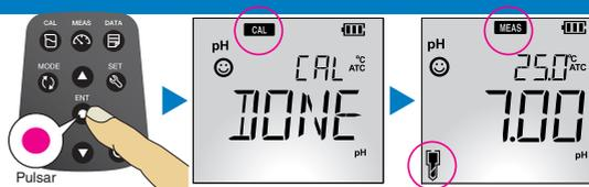
5. Repita los pasos del 1 al 4 para realizar la calibración de los siguientes buffers de pH.
