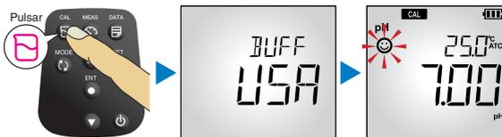
4. Pulse el botón ENT para confirmar la lectura de pH. Para cancelar la calibración, pulse la tecla MEAS.
