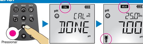
5. Repita os passos de 1 a 4 para realizar a calibração com o(s) buffer(s) de pH seguinte(s).
