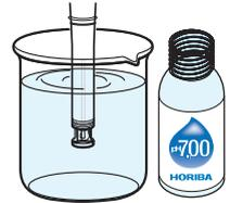
3. Drücken Sie die CAL-Taste auf dem Messgerät, um in den Kalibrierungsmodus zu schalten.
