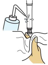
2. Tauchen Sie die pH-Elektrode in die pH-Pufferlösung.
