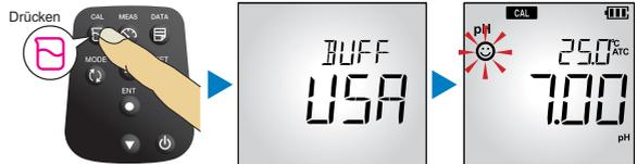
4. Drücken Sie die ENT-Taste, um die Ablesung des pH-Wert zu bestätigen. Drücken Sie die MEAS-Taste, zum Abbrechen der Kalibrierung.
