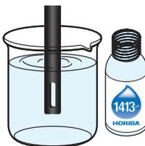
3. Pulse el botón CAL en el medidor para cambiar al modo de calibración.
