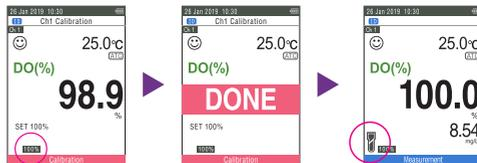
5. Immergere l'elettrodo DO in soluzione zero (solfato di sodio al 0,2%) e ripetere i passaggi nn. 3-4 per eseguire la calibrazione zero (opzionale).
