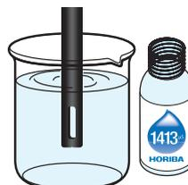
3. Premere il pulsante CAL sul misuratore per passare alla modalità di calibrazione.
