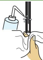
2. Immergere l'elettrodo di conducibilità in soluzione standard.
