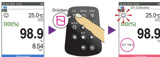
4. Drücken Sie die ENT-Taste, um die Ablesung des GS-Wert zu bestätigen. Drücken Sie die MEAS-Taste, zum Abbrechen der Kalibrierung.
