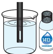
Beginnen Sie bei einer Mehrpunkt-Kalibrierung mit der niedrigsten Leitfähigkeitslösung. Gehen Sie zu Standardlösungen mit steigenden Leitfähigkeitswerten über.
