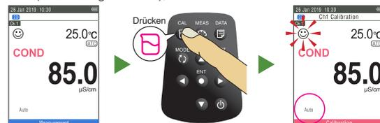
4. Drücken Sie die ENT-Taste, um die Ablesung der Leitfähigkeit zu bestätigen. Drücken Sie die MEAS-Taste, zum Abbrechen der Kalibrierung.
