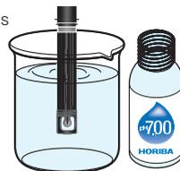
Effectuez un étalonnage à 3 points en utilisant les pH 7, 4 et 10 si vous n'êtes pas sûr(e) de la valeur estimée de l'échantillon. Il est recommandé de procéder à l'étalonnage d'abord avec le pH 7.
