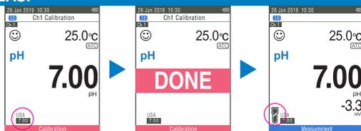
5. Répétez les étapes 1 à 4 pour effectuer l'étalonnage avec le ou les tampons de pH suivant(s).
