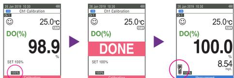
5. Plongez l'électrode OD dans une solution nulle (sulfite de sodium à 0,2%) et répétez les étapes 3 - 4 pour effectuer l'étalonnage du zéro (facultatif).
