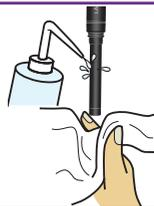
2. Placez l'électrode d'OD dans de l'air saturé en vapeur d'eau (flacon d'étalonnage avec une éponge humide) ou dans de l'eau saturée en air.
