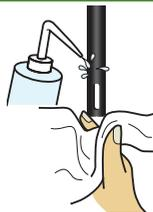
2. Plongez l'électrode de conductivité dans une solution étalon.
