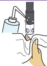
Non ci dovrebbero essere gocce d'acqua sulla membrana e sul sensore di temperatura.
