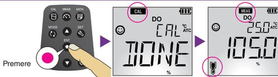
5. Immergere l'elettrodo DO in soluzione zero (solfito di sodio al 5%) e ripetere i passaggi nn. 3-4 per eseguire la calibrazione zero (opzionale).
