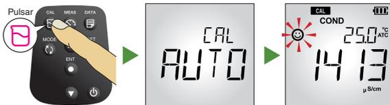
4. Pulse el botón ENT para confirmar la lectura de la conductividad. Para cancelar la calibración, pulse la tecla MEAS.
