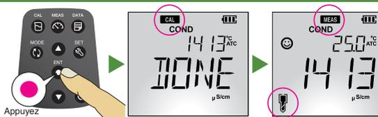
5. Répétez les étapes 1 à 4 pour effectuer l'étalonnage avec la ou les solution(s) étalon(s) suivante(s).
