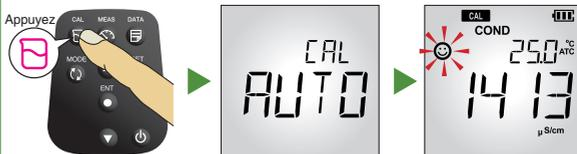
4. Appuyez sur le bouton « ENT » (« entrer ») pour confirmer le relevé du compteur. Pour interrompre l'étalonnage, appuyez sur le bouton « MEAS » (« mesure »).
