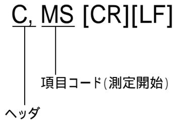
(インターバルメモリ無効時)指定モード(画面に表示されたCH、測定モード)での測定中となります。
