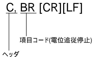
ホールド状態、測定中状態を解除し、瞬時値表示状態に戻します。
