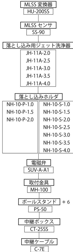
\* 6: 変換器、中継ボックス (CT-25pH) 及び取付金具 (MH-100) を取付けるポールスタンドになります。
