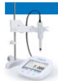
KCIを出さない革新的な pH電極。New ピュア IL電極 (9600-10D)
