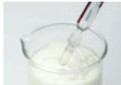
高粘性試料の測定に適したスリーブ型。
