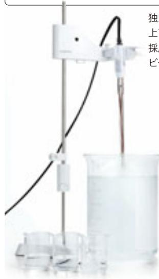
ロングタイプ電極スタンド\*なら電極を取り外すことなく、少ない標準液での校正と大型容器でのバッファ液などの調査に対応できます。
