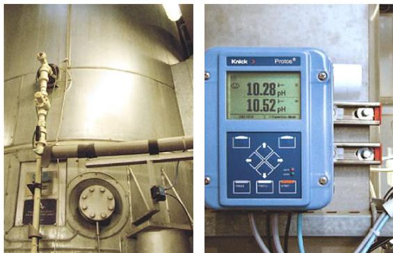
pHセンサには高温対応のガラスを採用し、安定性に優れたSE555を採用。加圧ゲルタイプの内部液を使用しており、補充不要。長期間安定した性能を発揮。
