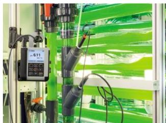
pH／導電率／溶存酸素センサーにはMemosens対応モデルを採用。非接触デジタル方式の恩恵により湿度・埃などの影響を受けず、信頼性の高いデータが与えられる。校正作業は測定現場よりセンサーを取り外し、ラボにて作業可能。センサーに取り付けられたメモリーには総使用時間・校正回数・ゼロ点／スロープデータなどがストアされているため、センサーのトラブルを未然に防止可能。
