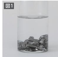
図1 油分抽出溶媒に部品試料を
