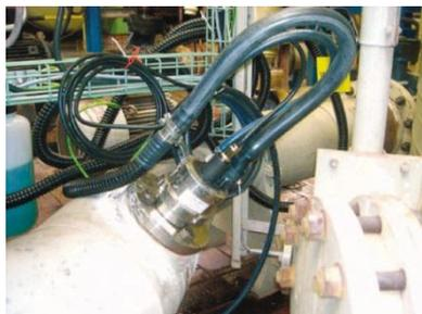
センサには高温・高圧条件での使用が可能で、かつ酸・アルカリに高い耐性を持つSE554を採用。液絡部を2つ設けることにより、安定した測定を実現。
