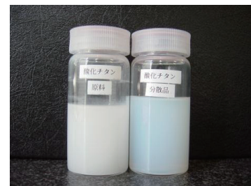
図 1: 粉碎前後 TiO 2 の写真 (左: 粉碎前、右: 粉碎後)
