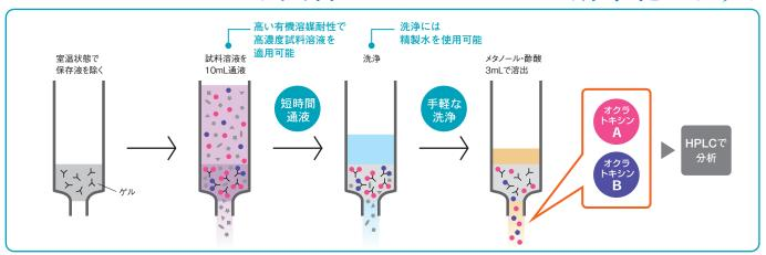
■高い有機溶媒耐性で、少量のサンプル溶液のみで迅速なクリーンアップが行えます。
