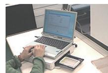
発色したプレートをスマートリーダーにセットし、吸光度を測定します。
