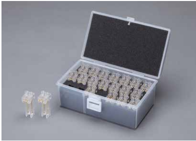
Cellules jetables pour potentiel Zêta (Cellules de 100 µl, milieu aqueux)
