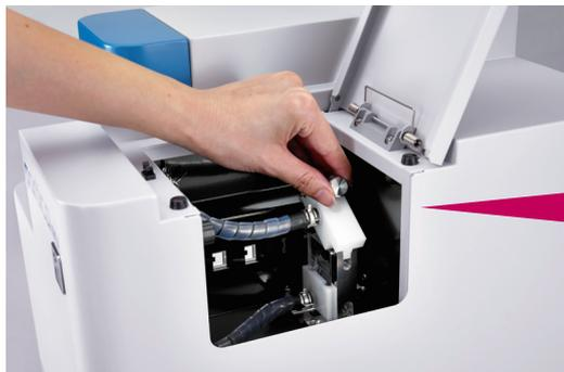
La limpieza de la celda de flujo es una de las rutinas de mantenimiento más esenciales. Por lo tanto, debe ser manipulada fácilmente por cualquier persona que opera el analizador. El sistema está diseñado para mantener suficiente espacio en la cámara de la celda para una fácil operación.
