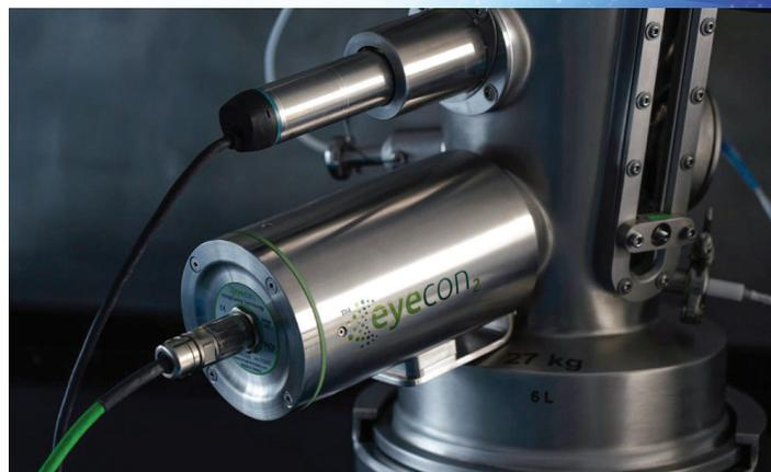
O revestimento do leito fluidizado (Wurster, por exemplo) pode ser obtido através da medição de tamanho de partículas in-line e em tempo real, e previsão de dissolução. Além disso, a granulação úmida contínua de rosca dupla pode ser executada para medição em tempo real, capturando sua importância, e caracterizando períodos dinâmicos. Estes e outros métodos foram testados em todo o mundo com resultados impressionantes.
