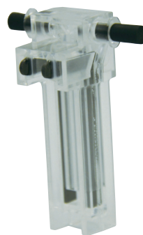
Figura 2: Una celda de potencial zeta con electrodo de carbono, utilizable después de varios cientos de mediciones
