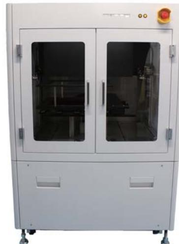
\* XGT-9000SL的大样品仓完全符合辐射安全的要求。虽然样品是在大气环境下检测，但检测器部分的运行可以选择真空模式或大气环境模式。
