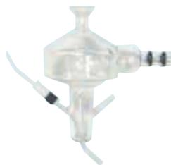
同时式氢化物发生装置（CMA）能够同时分析氢化元素以及其他元素，无需更换进样装置。
