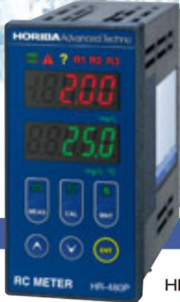
HR-480Pは、測定方式にポーラログラフ方式を採用したパネルマウントタイプの残留塩素計です。
