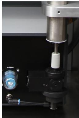
Abbildung 31: Verbindung des Sensoreingangs mit Feuchtekompensationsmodul IADS
