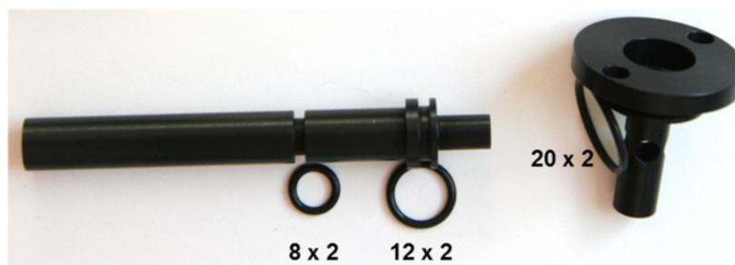
Abbildung 43: Aerosoleinlass, Sensoreinlass
