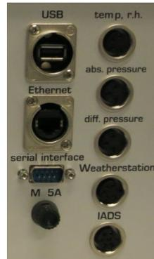
**Abbildung 5: Anschlussmöglichkeiten auf der Rückseite der APDA-372 Steuereinheit**
