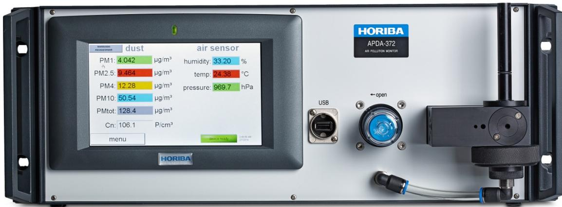
Abbildung 3: Vorderseite der APDA-372 Steuereinheit
