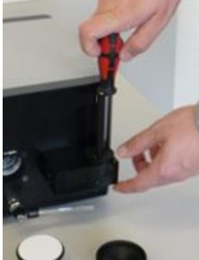
**Abbildung 33: Lösen der M3 Kreuzschlitzschrauben**
