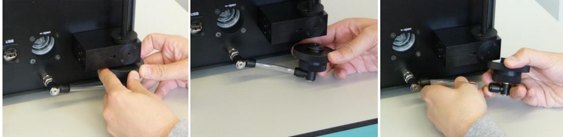
Abbildung 29: (A-C) Entfernen des Filterhalters
