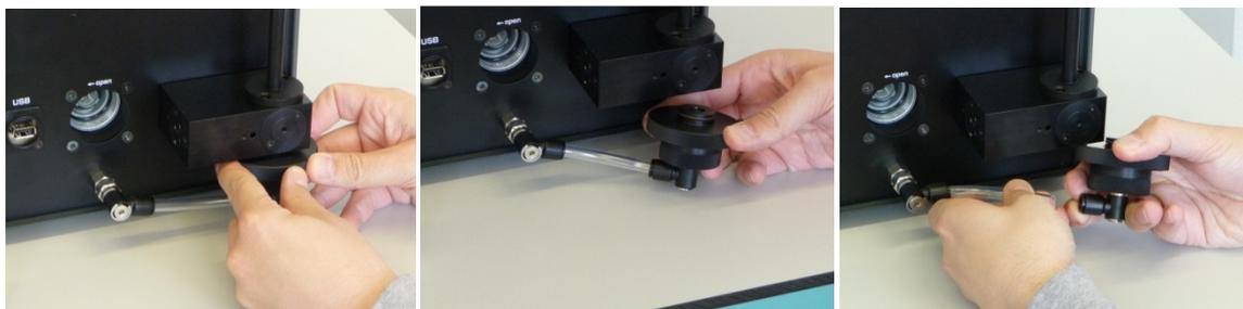
Abbildung 32: (A-C) Entfernen des Filters
