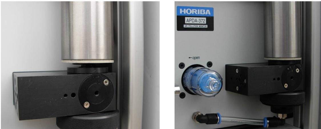
**Abbildung 11: links falsche Position des Probenahmerohres, rechts richtige Position**
