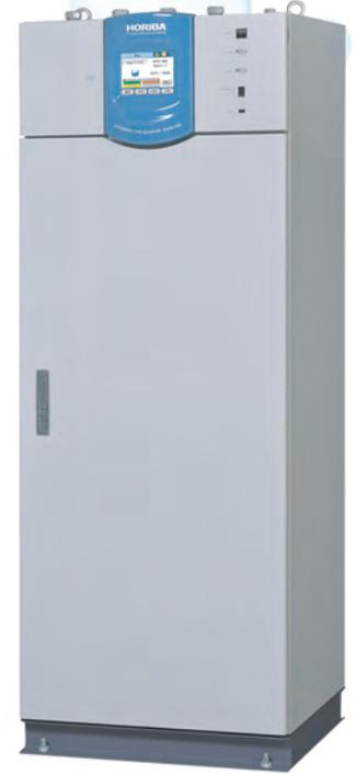
모든 TOC 측정 방법의 기초는 유기결합 탄소가 이산화탄소(CO<sub>2</sub>)로 산화되는것입니다. 습식 산화 혹은 고온 산화 공정을 통해 유기결합 탄소가 CO<sub>2</sub>로 검출되고 정량화됩니다. 검출 된 CO<sub>2</sub>는 감도가 높고 세밀한 NDIR 센서에 측정되어 데이터로 환산됩니다. TOC와 관련하여 TIC, NPOC, POC, VOC 등의 연관 관계는 아래의 그림과 같습니다.
