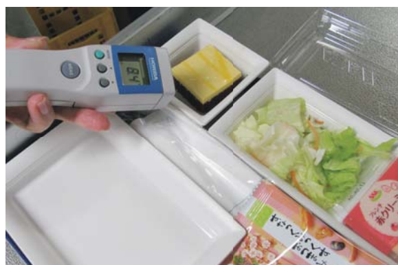
▲食材の盛り付け時の温度チェック。規定通りの「15℃以下」が守られているかをHORIBAの放射温度計で正確に測定します。
