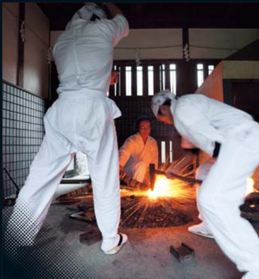
【上】——月山伝の大きな特徴である、 柾目が大きく波を打ったような綾杉肌の地肌と小籠。 【左】——鍛錬中の月山氏。 火花や鋼の色はもちろん、手に伝わる振動などで、 鋼に含まれる炭素のバランスを判断する。 籠を打つ「向こう籠」にも技量が要求される。
