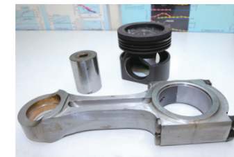
◀ 新エシイーで研究開発するスーパークリーンディーゼルエンジンのパーツ
