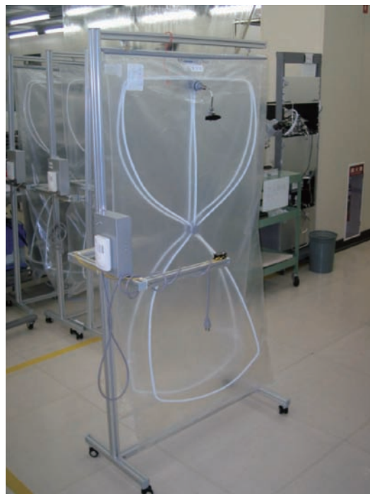
(株)堀場エステックで導入した温室効果ガス回収設備
