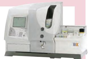
人間や動物の健康状態の測定に欠かせない血液検査で、血液中の赤血球・白血球の個数をはじめ、ヘモグロビン濃度、血小板の個数を測定します。
