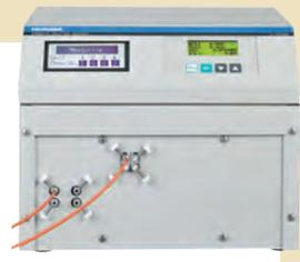
半導体洗浄工程で洗浄液濃度を監視する小型モニターで、洗浄液の無駄を省きプロセスの最適化および生産ラインの歩留り向上に貢献しています。
