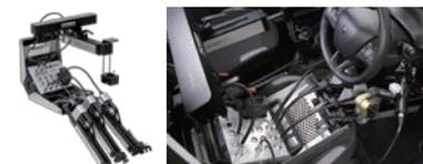
航続距離や電費を評価する試験では、試験時間の長期化が課題となっています。HORIBAはドライバーに代わり試験車両を運転するシステムを提案しています。走行・シフト操作などを自動化し、試験負荷と作業ミスを低減し、開発を加速させます。
