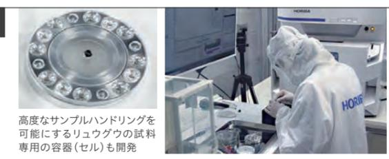
高度なサンプルハンドリングを可能にするリュウグウの試料専用の容器(セル)も開発
